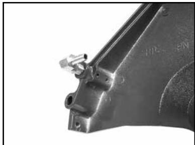
(D) Remove the Blade Guard Intake Fitting.
