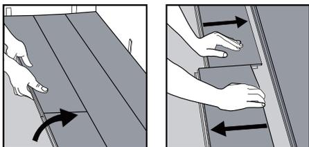
Para separar toda la fila levántela delicadamente en ángulo. Para separar uniones de los extremos de tabloncillos individuales en una misma fila, déjelos acostados en el piso y deslícelos mientras los separa. Si los tabloncillos no se separan fácilmente, puede levantar levemente los tabloncillos (ángulo de 5°) cuando los desliza y los separa.
