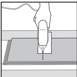
**4** Si corta con una sierra caladora, la superficie laminada debe mirar hacia abajo. Si corta con un serrucho, la superficie laminada debe mirar hacia arriba.
