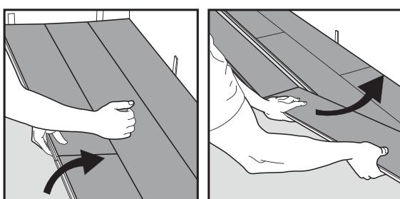
Para separar toda la fila levántela delicadamente en ángulo. Para separar uniones de los extremos de tablones individuales en una misma fila, déjelos acostados en el piso y deslícelos mientras los separa. Si los tablones no se separan fácilmente, puede levantar ligeramente los tablones (ángulo de 5°) cuando los desliza y los separa.
