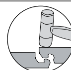
Posición de las planchas: Incorrecta
